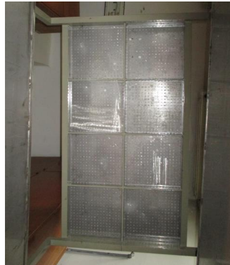
Slika 12 Realizacija uređaja za proveru zaštite od kapljica vode koje vertikalno padaju
