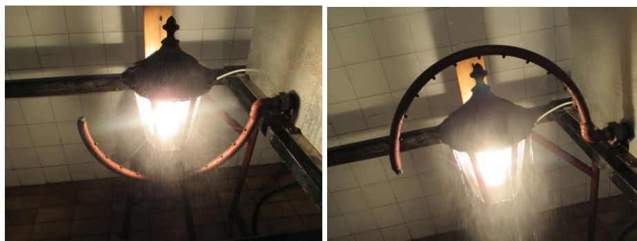
Slika 26 Ispitivanje druge cifre IP zaštite ispitnim lukom
