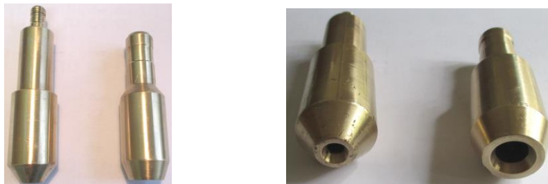
Slika 15 Realizacija mlaznica (za ispitivanje druge karakteristične brojke 5 i 6)
