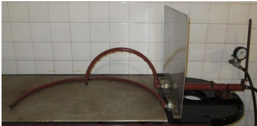
Slika 13 Realizacija osciljuće cevi (dve cevi poluprečnika 200mm i 400 mm)
