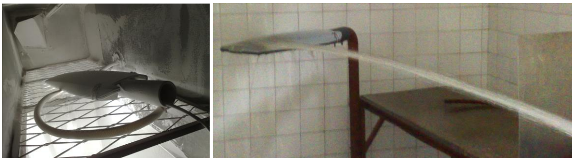
Slika 18 Ispitivanje svetiljke za uličnu rasvetu na prašinu i vodu
