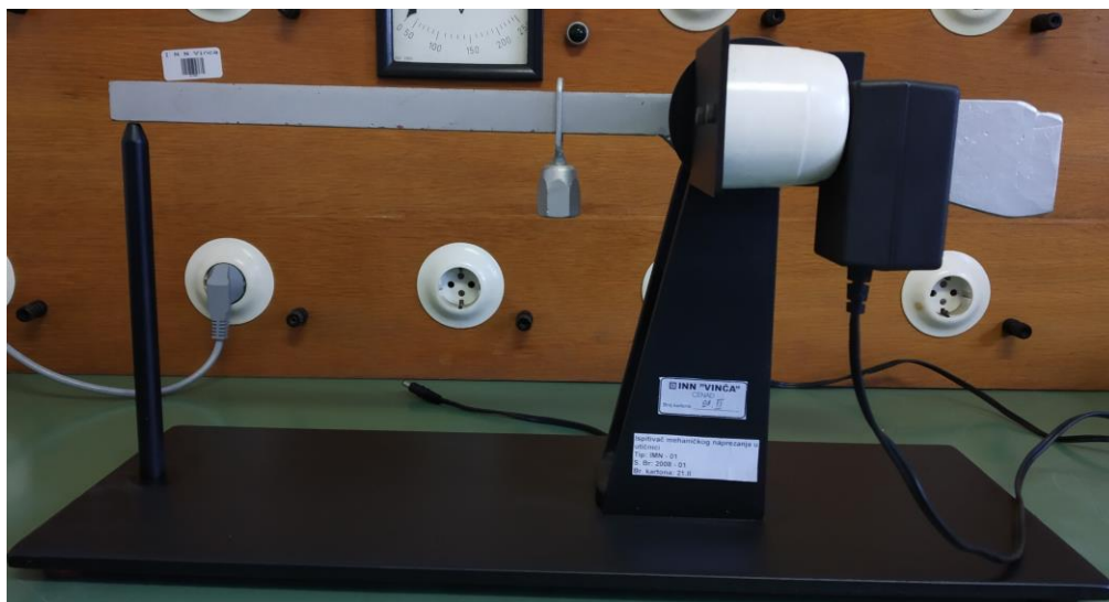
Slika 5b. Fotografija aparature za ispitivanje mehaničkog napreznja u utičnici
