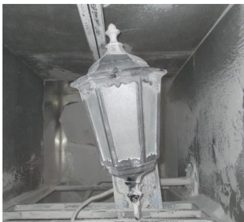
Slika 27 Ispitivanje prve cifre IP zaštite prašinarom
