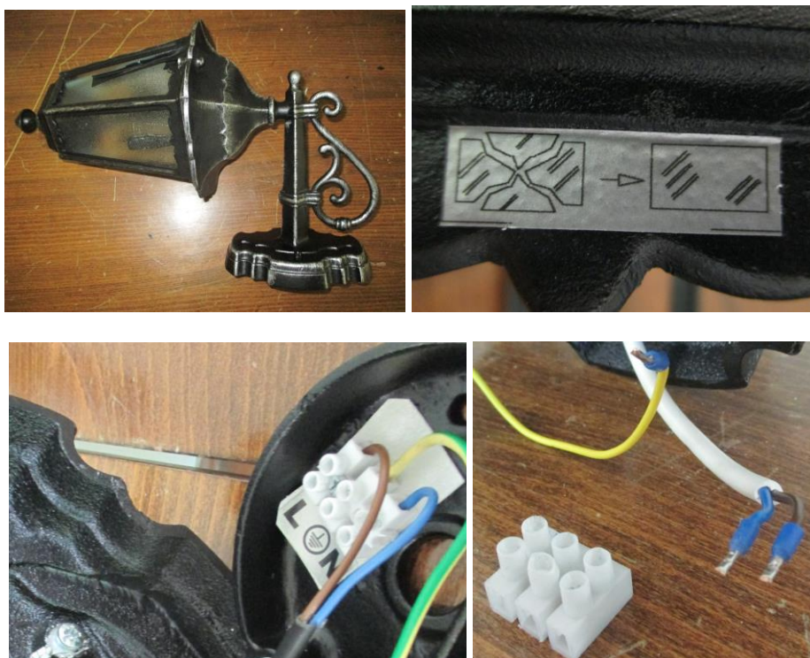
Slika 25 Ispitivanje obeležavanja i priključivanja
