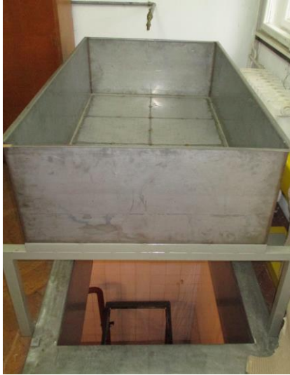
Slika 12 Realizacija uređaja za proveru zaštite od kapljica vode koje vertikalno padaju
